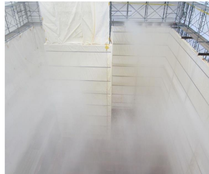
第6図 スプレイ時の試験状況(スプレイ量: 120m 3 /h)
