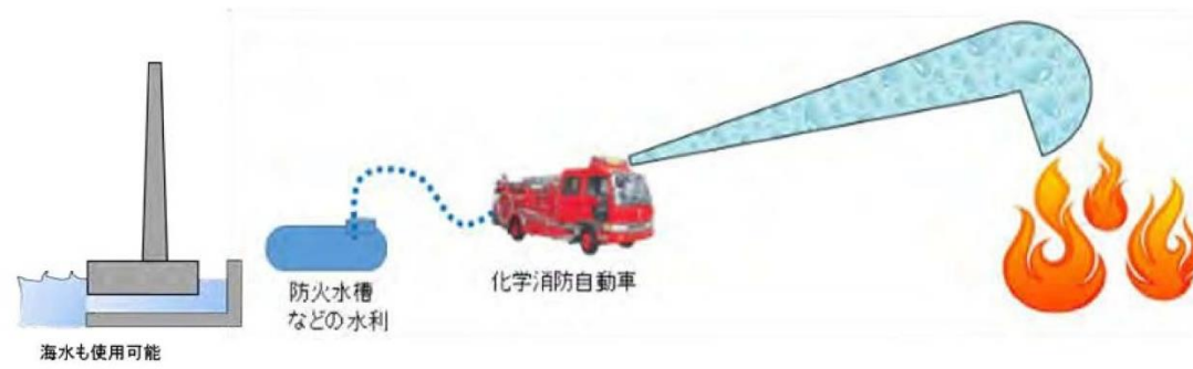
図 8-2 化学消防自動車による泡消火
