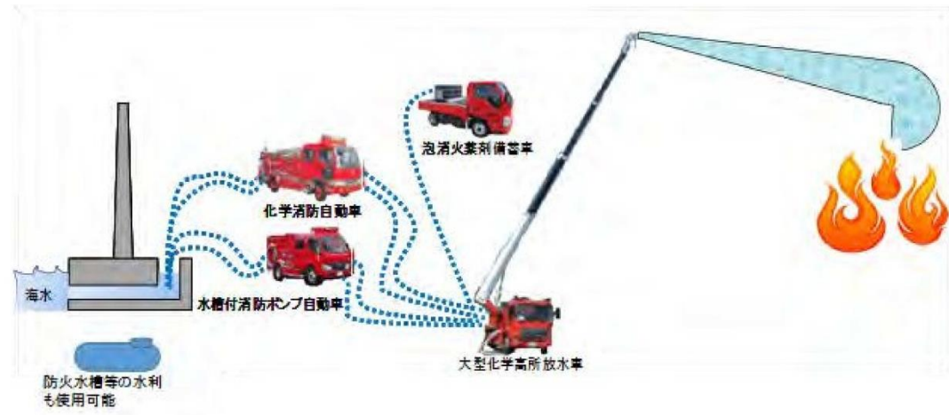
図 8-1 大型化学高所放水車による泡消火
