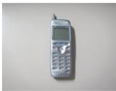
電力保安通信用電話設備 (PHS 端末)
