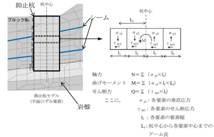
第 6.3-12 図 断面力算定の概念図
