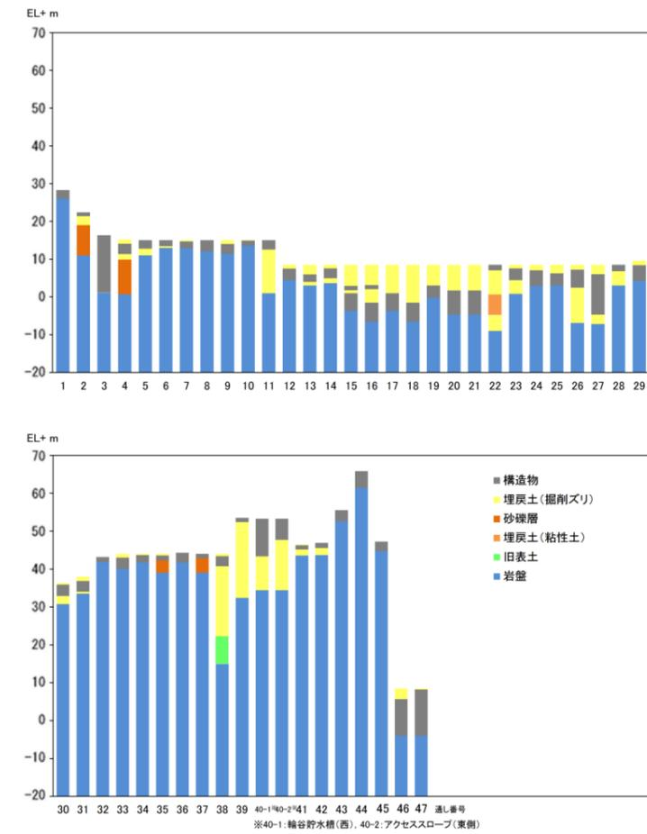
第4図 段差評価位置の地質構成
