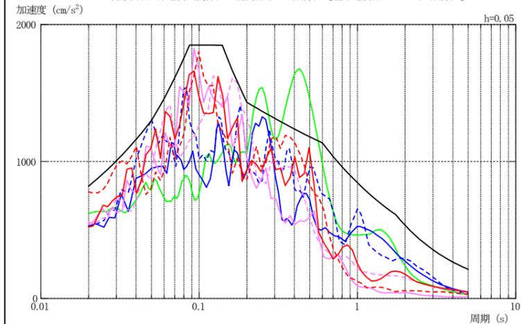
第 6.3-15 図 基準地震動 Ss の加速度応答スペクトル
