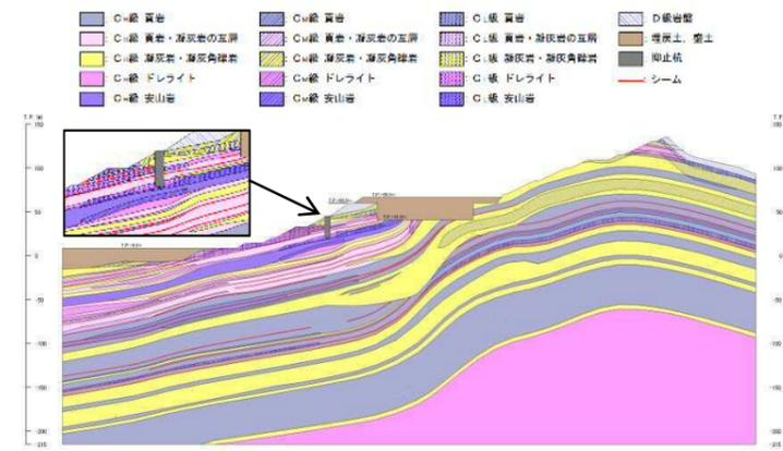
第 6.3-11(1)図 ②-②' 断面 解析用岩盤分類図
