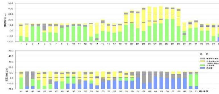
第5図 段差評価位置の地質構成
