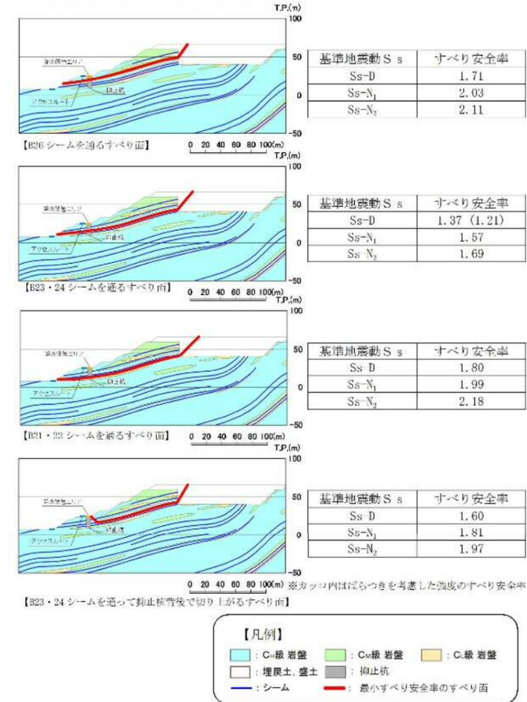
第 6.4-3 図 ①-①' 断面の評価結果
