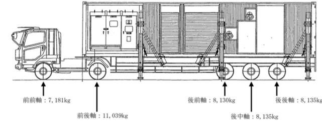
第4図 移動式代替熱交換設備
