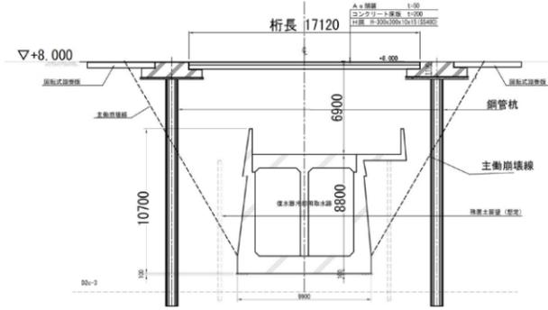
第1図 評価箇所断面図
