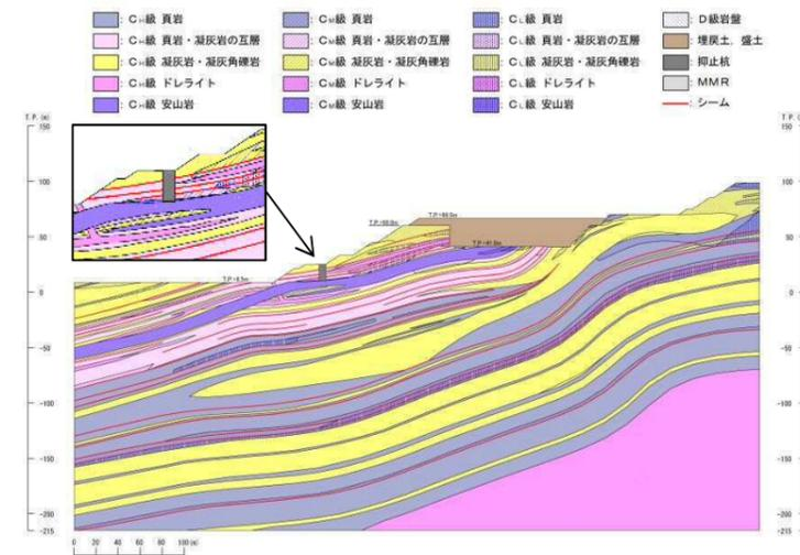
第 6.3-10(1) 図 ①-①' 断面 解析用岩盤分類図
