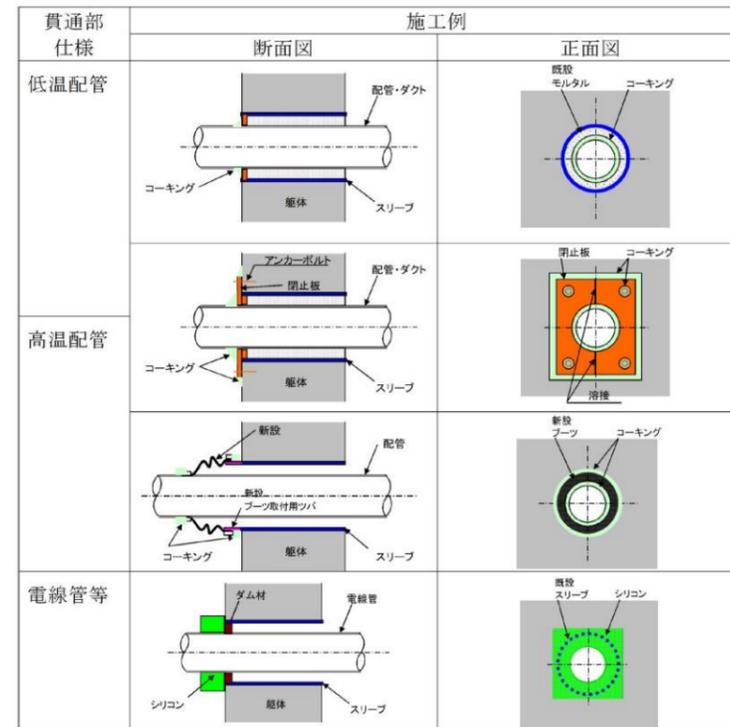
第5図 貫通部止水対策 (施工例)
