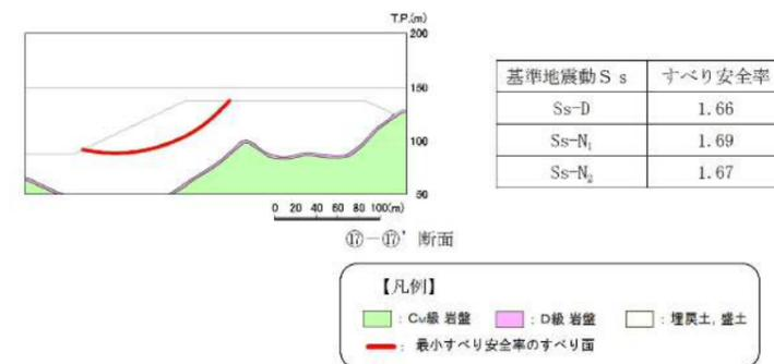
第 4.6-3 図 グループ C (T. P. +88m) の断面の評価結果
