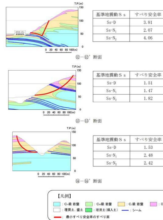
第 4.6-2 図 グループ B (T. P. +44m~50m) の断面の評価結果
