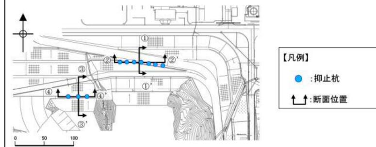
抑止杭配置平面図
