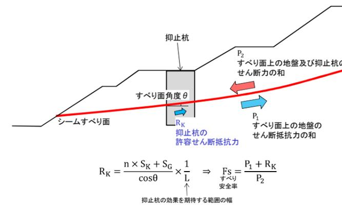
抑止杭のせん断抵抗力算出イメージ断面図
