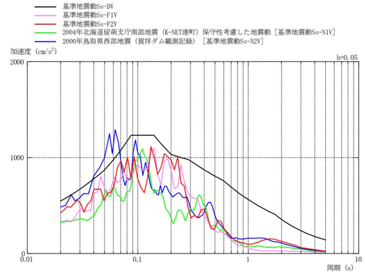
第 6.3-17 図 基準地震動 S s の加速度応答スペクトル
