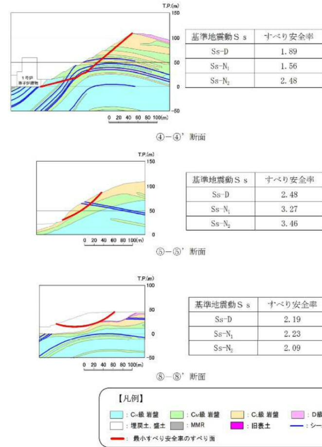
第 4.6-1 図 グループ A (T.P. +15m 程度) の断面の評価結果
