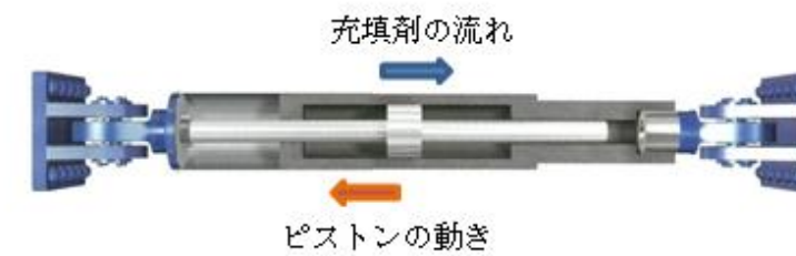
第2-4図 単軸粘性ダンパの動作原理
