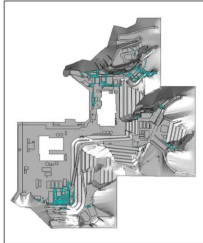
図 10-3-2 屋外タンクの溢水伝播挙動 (1/2)
