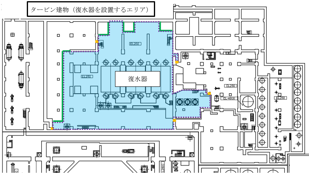
第4.2-11図 復水器エリア水密扉 設置位置
