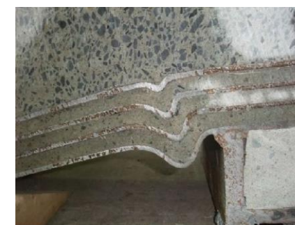
圧縮縁はらみ出し状況
