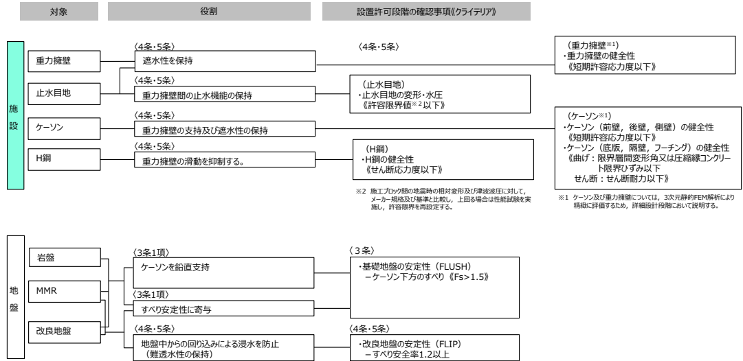
第 1-107 図 設置許可段階における確認項目 [防波壁（波返重力擁壁）]
