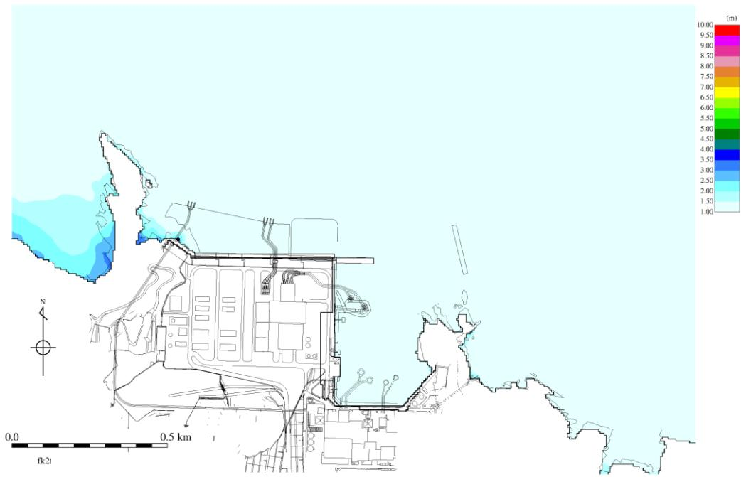
図4(1) 海域活断層上昇側最大ケース（防波堤有り） 最高水位分布
