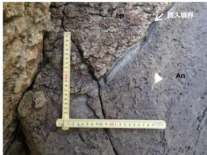
図2-8（13）防波壁（東端部）露頭状況
