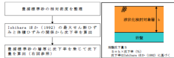
第6図 排水沈下量の算定フロー
