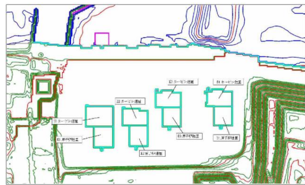
添付第 4-31 図(1) 地形モデル図 [主要建屋 (原子炉建屋, タービン建屋) を考慮したケース]
