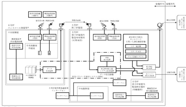
図 3.19-1 通信連絡設備の系統概要図
