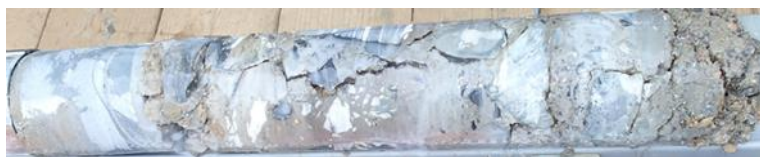
第3-1-2 図 GPサンプリングにより採取した埋戻土（掘削ズリ）
