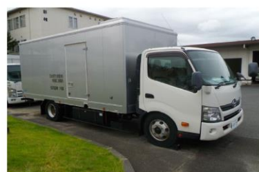
可搬型代替低圧電源車
