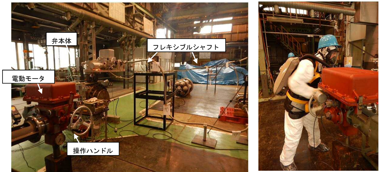
図6 モックアップ試験概略
