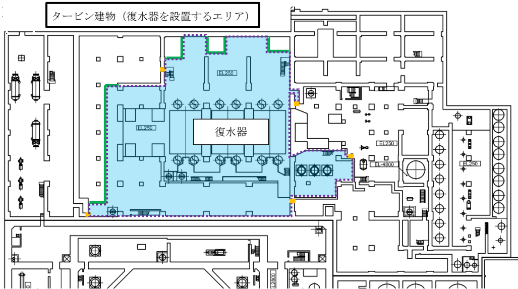
第4.2-11図 復水器エリア水密扉 設置位置
