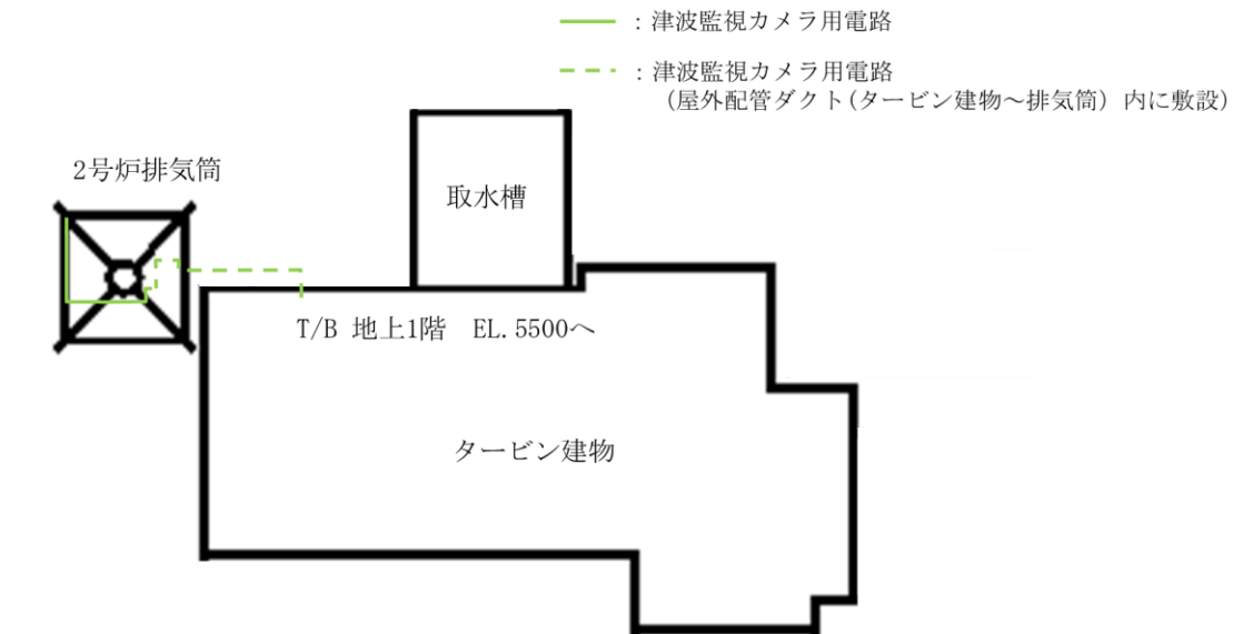
第3-3図 島根原子力発電所2号炉 上位クラス屋外露出電路配置図 (4/4)
