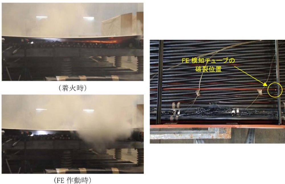
第7図 試験H2における発火・消火時の状態
