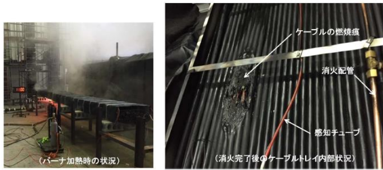
第 14 図：加熱時及び消火後の状態
