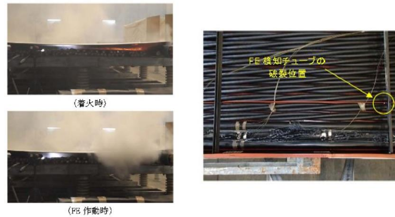
第 7 図 試験 H2 発火・消火・試験後の状態
