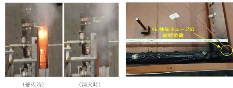
第 9 図 試験 H2 発火・消火・試験後の状態
