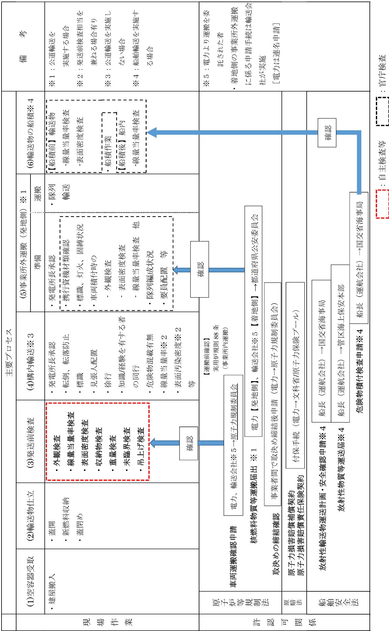
A型、L型、IP型の運搬物の事業所外運搬に関する主要プロセス・工程の例（核燃料物質を封入しているものの除く）
