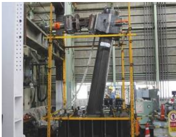
最大荷重時座屈状況
