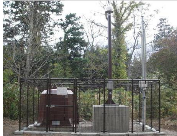
湯坂地点の観測装置 左) 地震観測施設 右) GPSアンテナ
