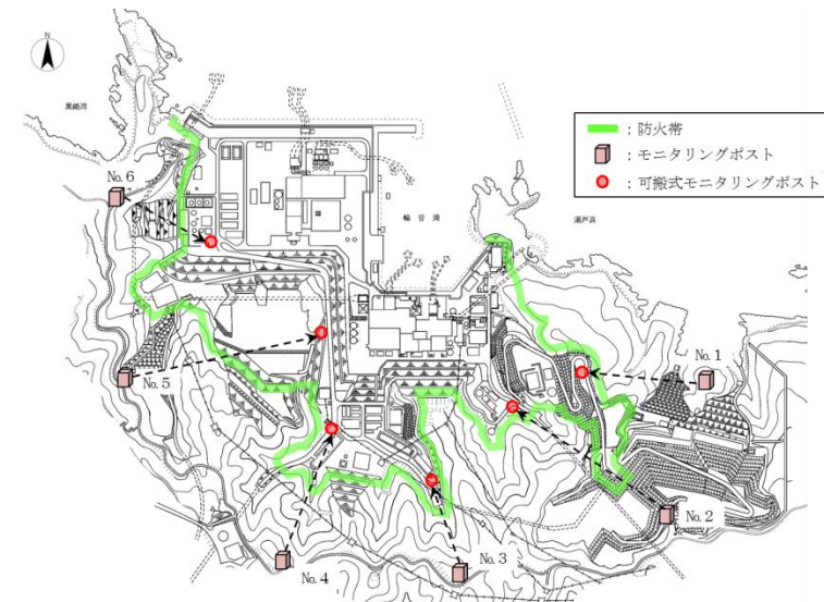
第2.3.3-2図 可搬式モニタリングポスト設置位置
