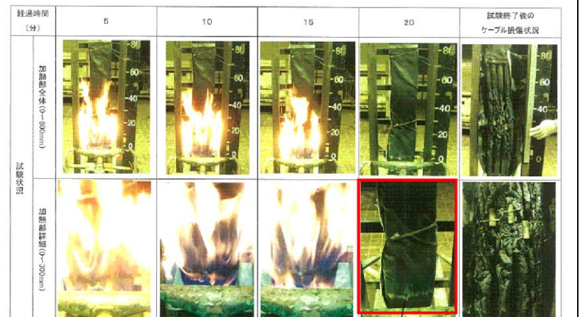
第 2 図 防火シートの IEEE383 垂直トレイ燃焼試験実施後の状態
