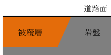
第 4 図 岩盤と被覆層との境界部の状況
