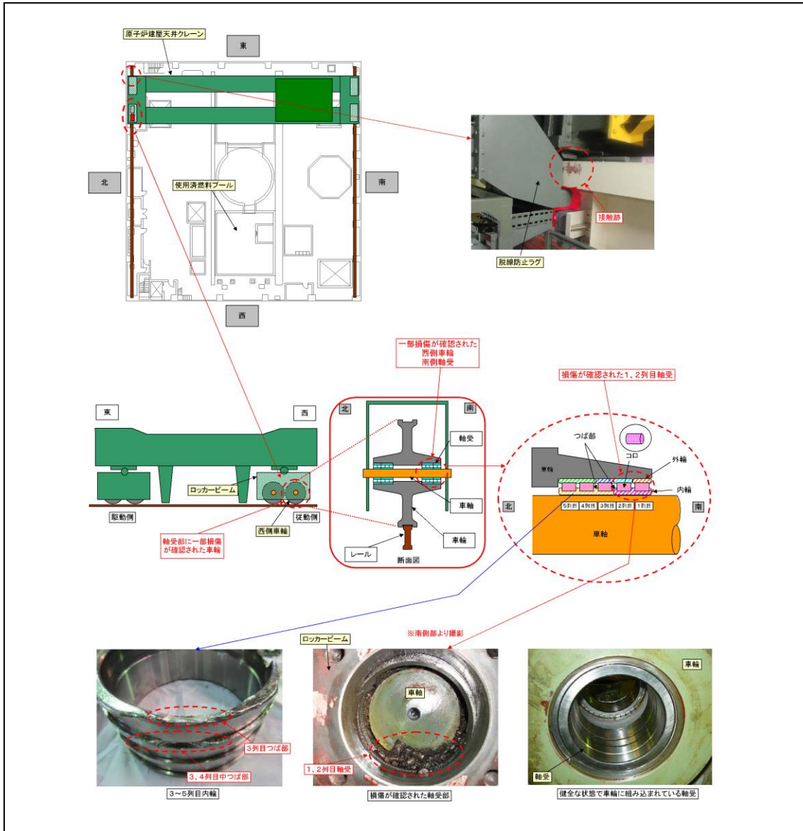
第3図 福島第二原子力発電所3号炉 原子炉建屋クレーンの損傷状況について
