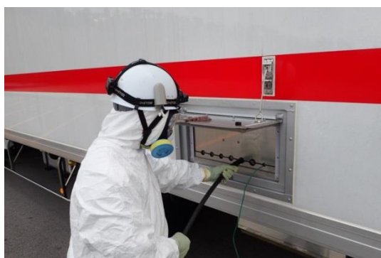
ケーブル接続作業
