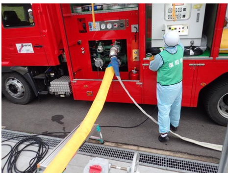
大量送水車起動
