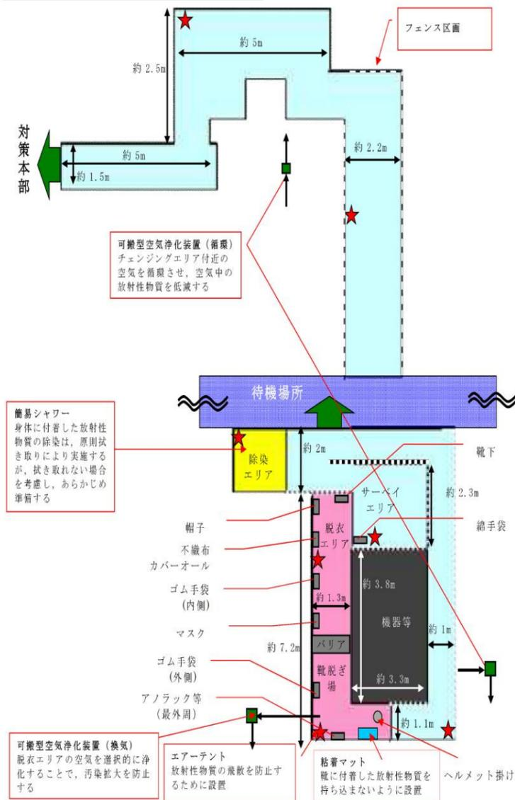
第5図 5号炉原子炉建屋内緊急時対策所チェンジングエリア
