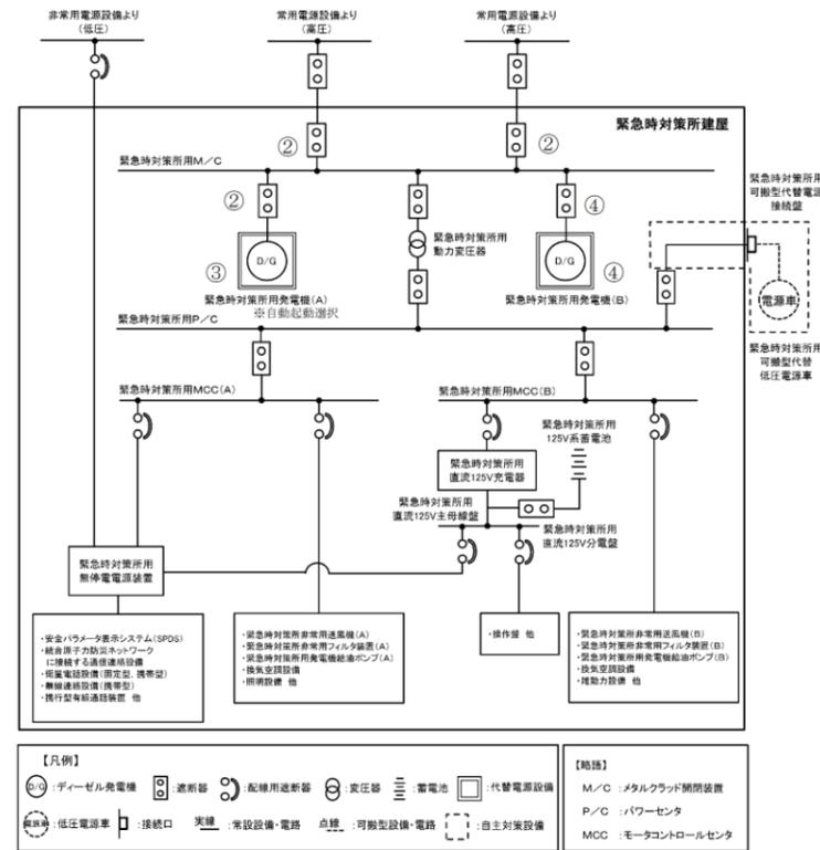
※○数字は、緊急時対策所用発電機 (A) を自動起動とし、緊急時対策所用発電機 (B) を手動起動する場合の給電手順にて、操作する遮断器及び機器を示す。
