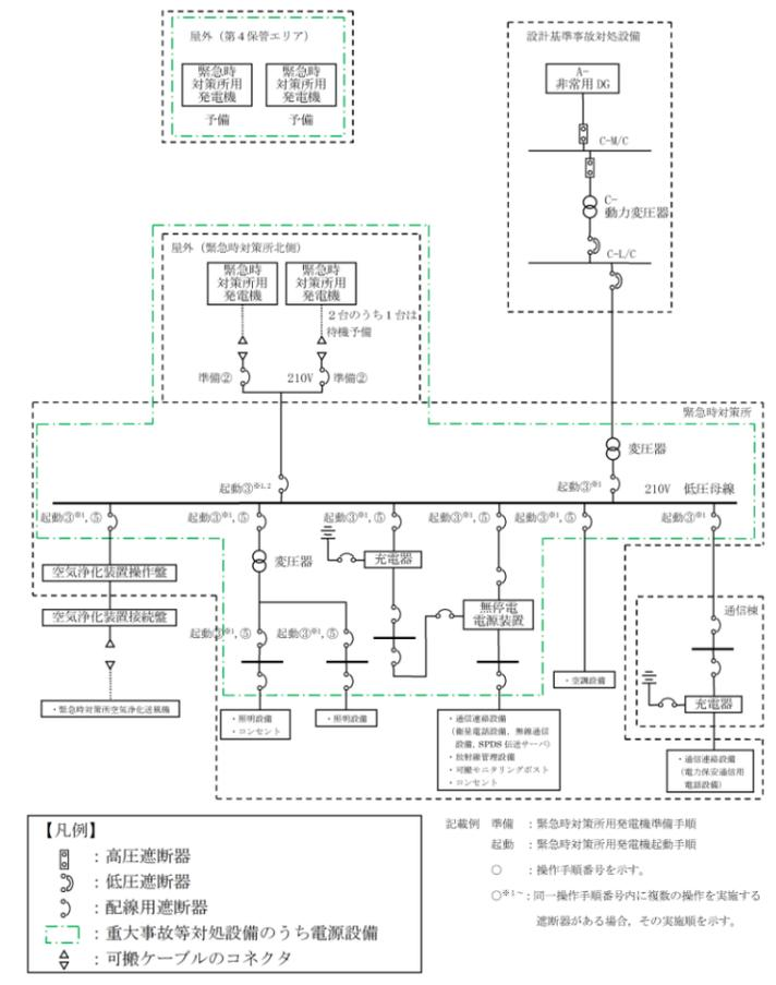
第 1. 18-16 図 緊急時対策所 給電系統概要図
