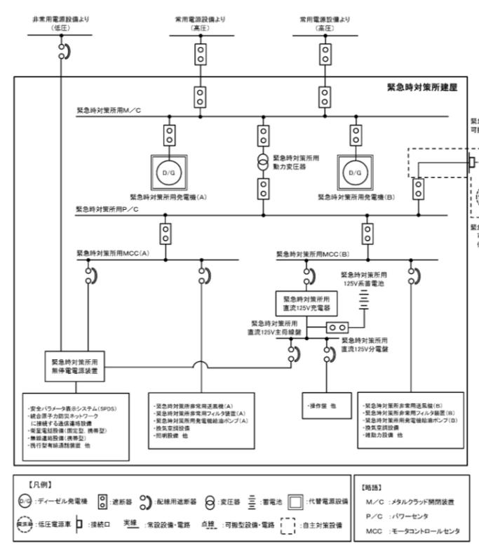
第 1. 18. 2. 4-1 図 緊急時対策所電源系統概略図
