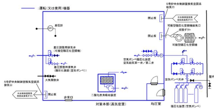
第3図 5号炉原子炉建屋内緊急時対策所(対策本部)換気設備系統概略図(プルーム通過中:陽圧化装置(空気ポンプ)による陽圧化)
