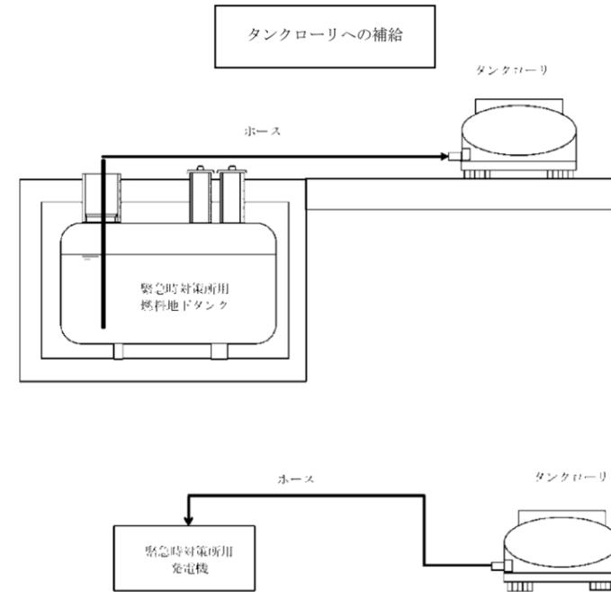
第 1. 18-20 図 緊急時対策所用発電機燃料タンクへの燃料給油 概要図
