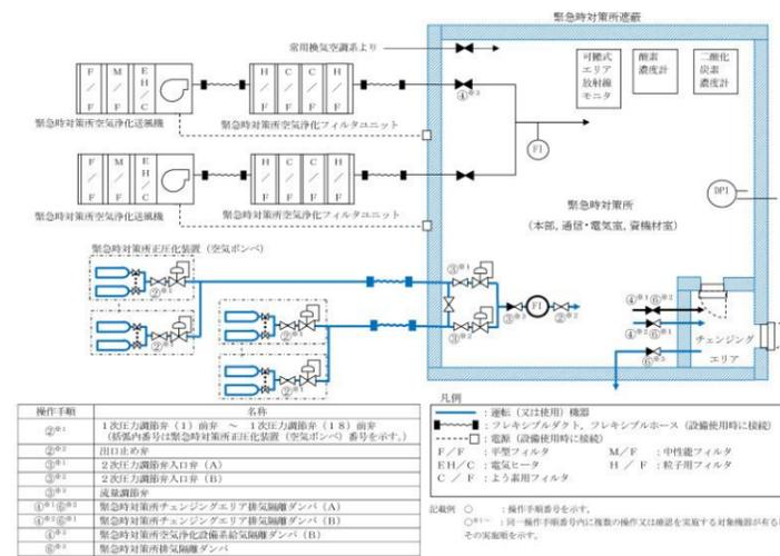
第2図 緊急時対策所換気空調設備 概要図(プルーム通過中:緊急時対策所正圧化装置(空気ポンプ)による正圧化時)
