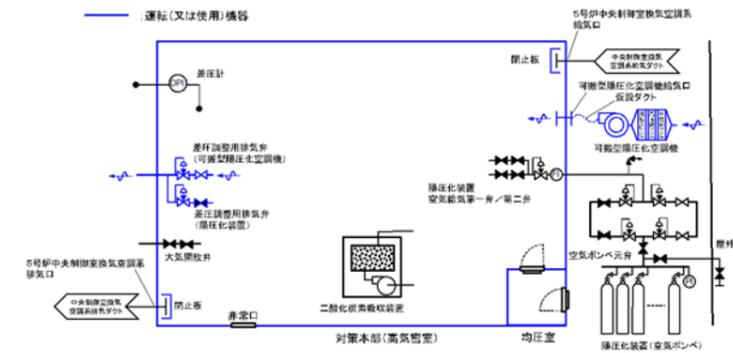
第 1.18.2 図 5号炉原子炉建屋内緊急時対策所(対策本部)換気設備 系統概略図(プルーム通過前及び通過後:可搬型陽圧化空調機による陽圧化)
