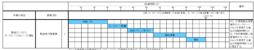
図 3.14-8 軽油タンクからタンクローリ (4kL) への燃料補給のタイムチャート
