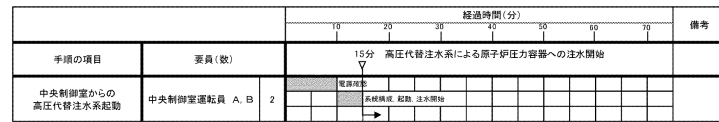
図 3.2-2 中央制御室からの高圧代替注水系起動のタイムチャート*
