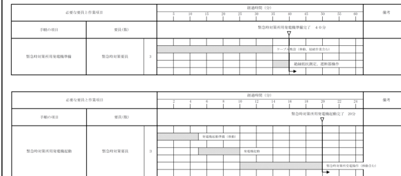
第3.18-4 図 緊急時対策所用発電機準備及び起動のタイムチャート*
