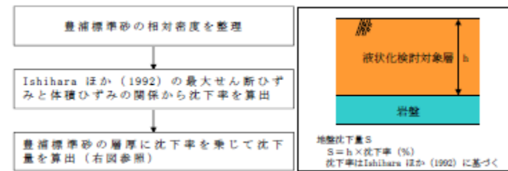
第6図 排水沈下量の算定フロー
