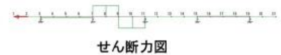
第3-68図 漂流物荷重の位置と曲げモーメント図・せん断力図の関 係
