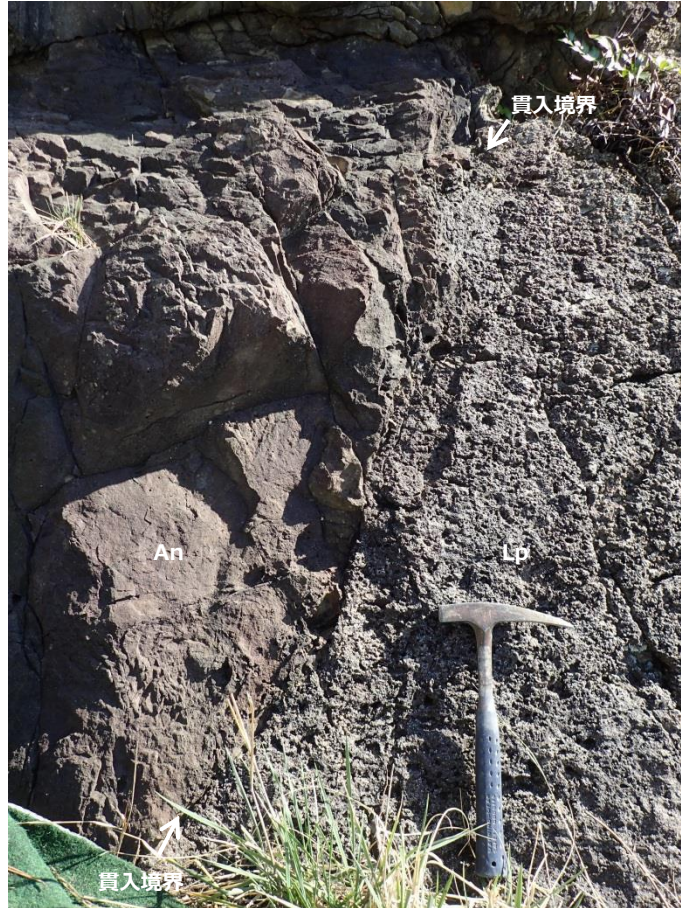
図2-8 (15) 防波壁(東端部)露頭状況 P15 安山岩岩脈 (An)下盤境界 貫入境界は火山礫凝灰岩 (Lp) に密着する。
