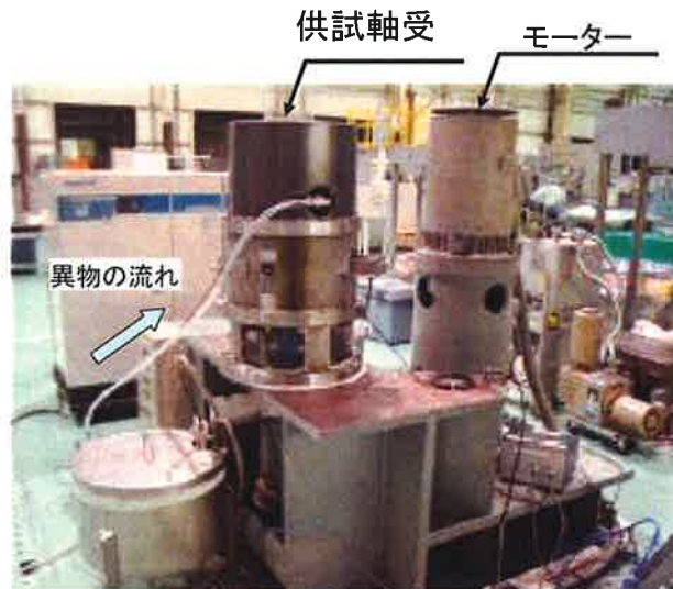
図-2 海水ポンプ軸受摩耗試験装置
