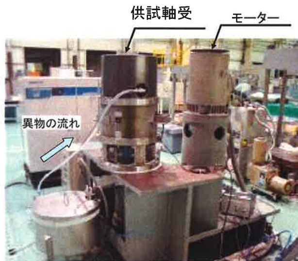
図-2 海水ポンプ軸受摩耗試験装置
