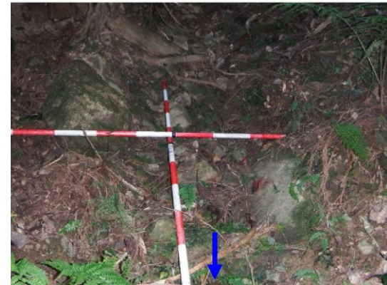
写真② 0.7 × 0.3 × 0.5 : 粒径 : 0.50m 0.5 × 0.3 × 0.7 : 粒径 : 0.50m
