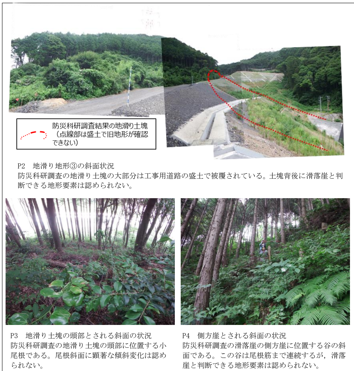
図-29 地滑り地形③周辺の露頭写真
