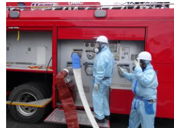
ポンプ起動操作（昼間）
