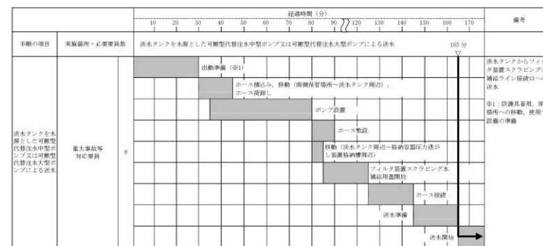
第 1.13-7 図 可搬型代替注水中型ポンプ又は可搬型代替注水大型ポンプによる送水（淡水/海水）タイムチャート (5/6)
