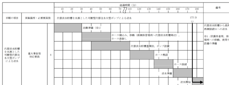
第 1.13-7 図 可搬型代替注水中型ポンプ又は可搬型代替注水大型ポンプによる送水 (淡水/海水) タイムチャート (3/6)
