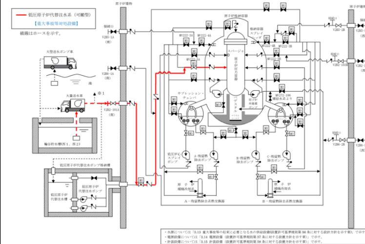
図 3.4-2 A - 低圧原子炉代替注水系(可搬型)系統概要図
