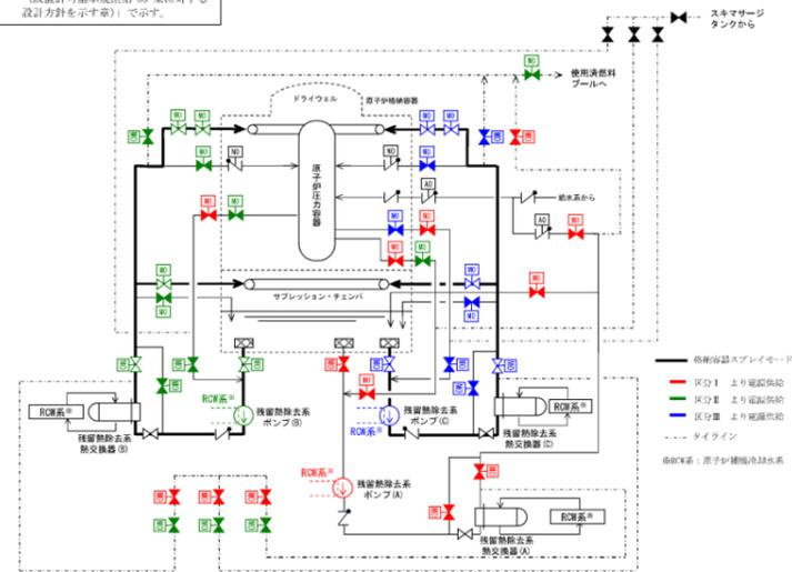
図 3.6-6 残留熱除去系（格納容器スプレイ冷却モード）系統概要図
