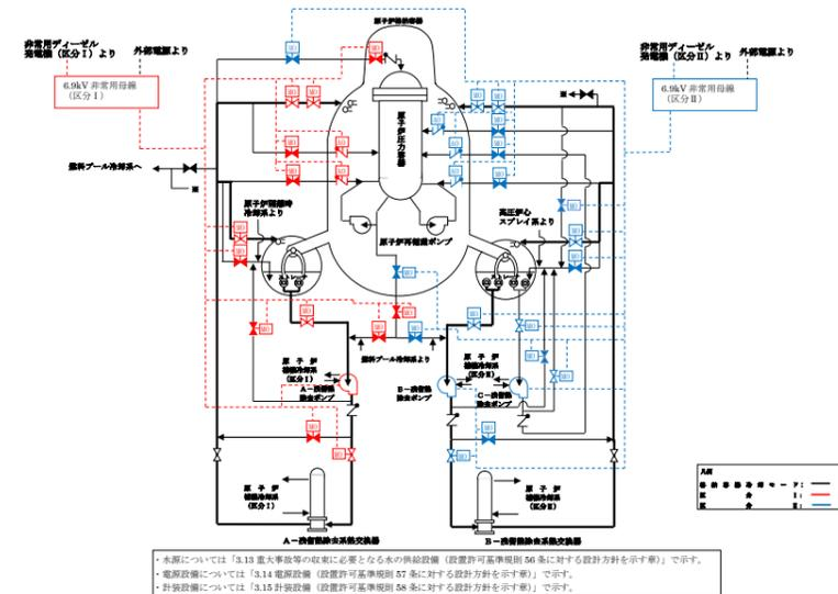
図 3.6-6 残留熱除去系（格納容器冷却モード）系統概要図
