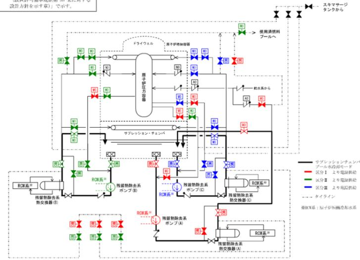
図 3.6-7 残留熱除去系（サブプレッション・チェンバ・プール水冷却モード）系統概要図
