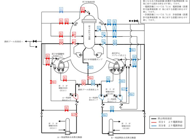
図 3.4-7 残留熱除去系 (原子炉停止時冷却モード) 系統概要図
