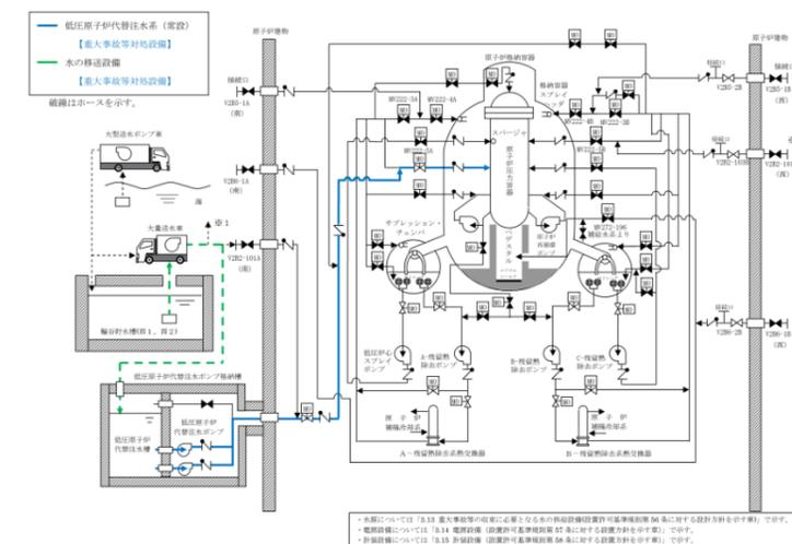
図 3.4-1 低压原子炉代替注水系（常設）系統概要図
