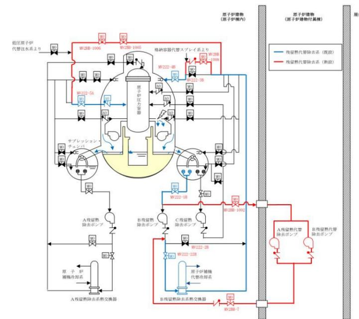
図 3.7-4 残留熱代替除去系 系統概要図
