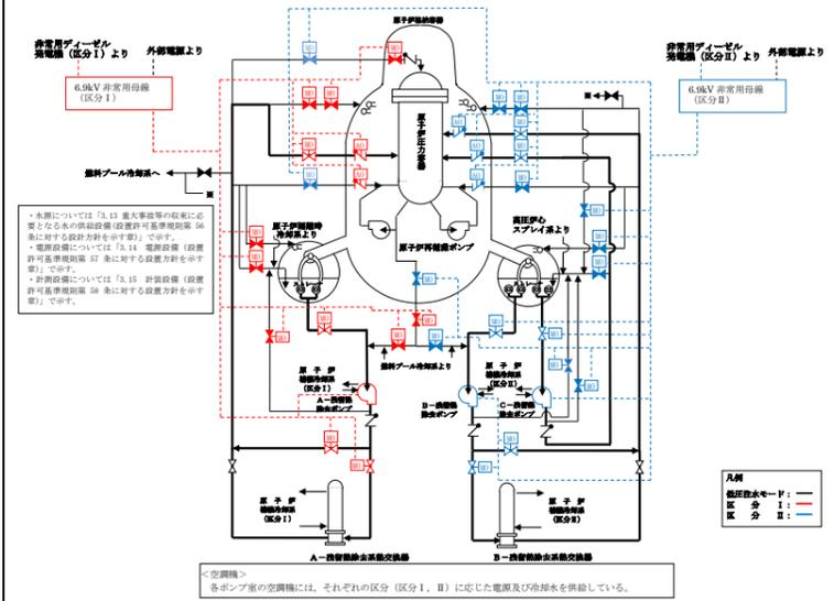
図 3. 4-6 残留熱除去系（低圧注水モード） 系統概要図
