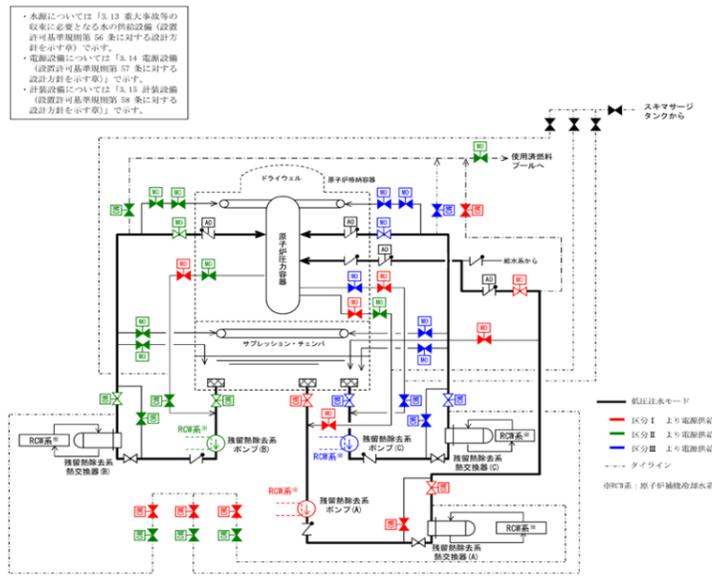
図 3. 4-5 残留熱除去系（低圧注水モード） 系統概要図
