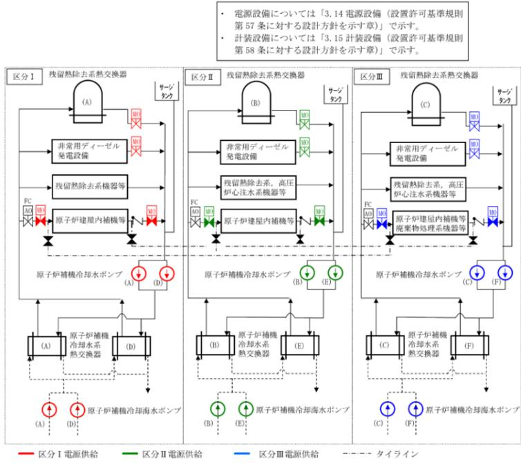
図 3.5-7 原子炉補機冷却系 系統概要図
