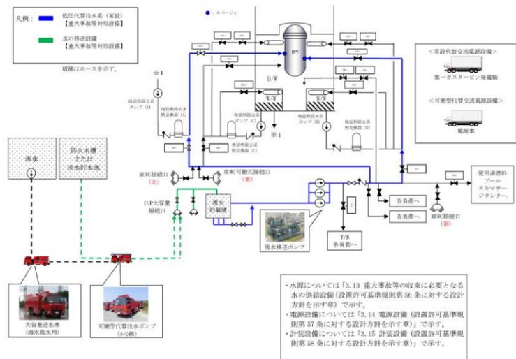
図 3.4-1 低压代替注水系（常設）系統概要図
