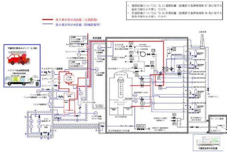
図3.7-1 格納容器圧力逃がし装置 系統図
