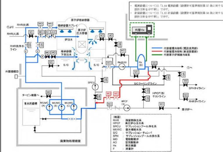
図 3.7-4 代替循環冷却系 系統概要図
