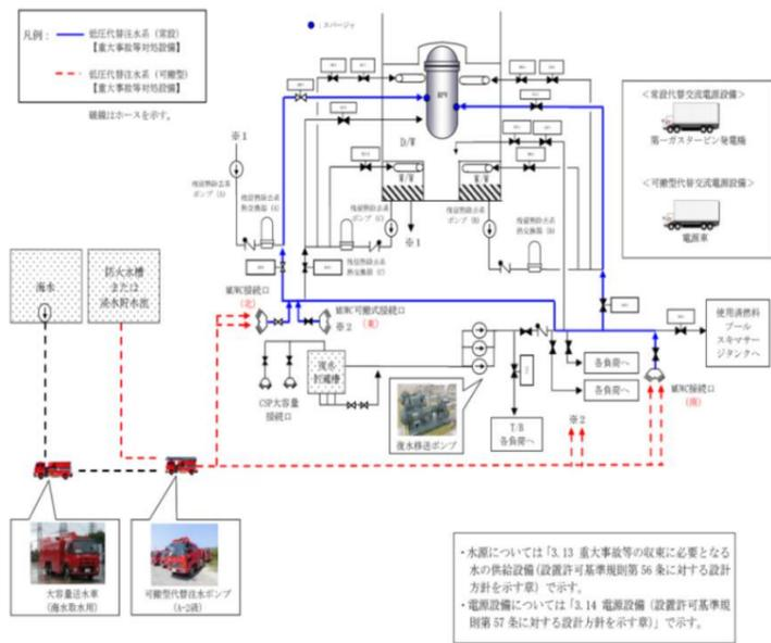
図3.4-3 低圧代替注水系(可搬型)系統概要図
