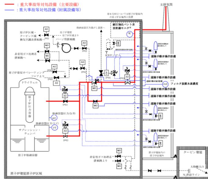
図 3.5-4 耐圧強化ベント系系統概要図
