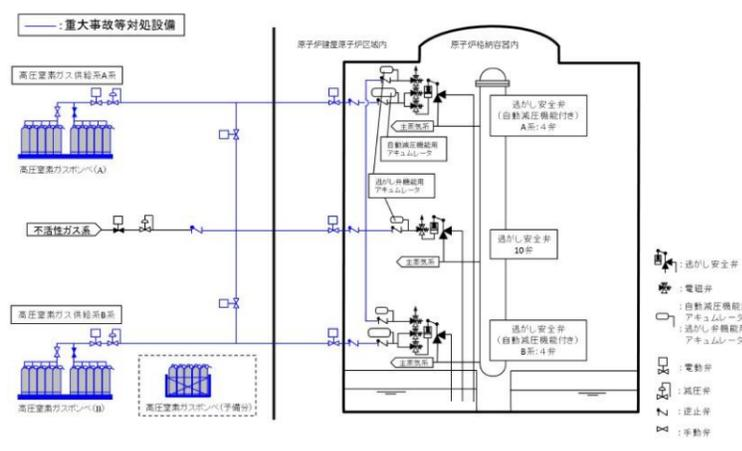
図 3.3-6 高压窒素ガス供給系 系統概要図
