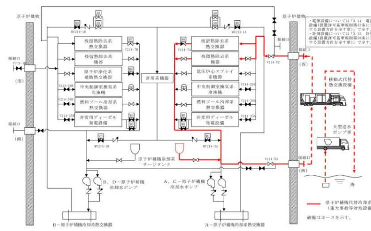
図 3.5-1 代替原子炉補機冷却系 系統概要図 (A号機の列 (B号機も同様))
