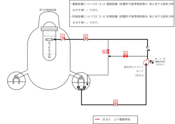
図3.4-5 低圧炉心スプレー系 系統概要図
