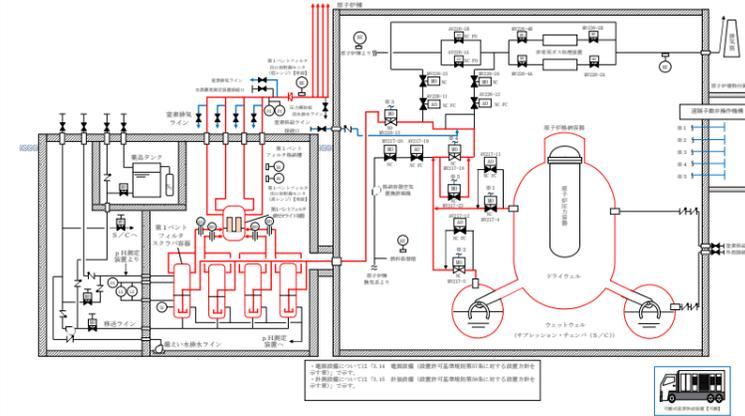
図 3.5-5 格納容器フィルタベント系 系統概要図
