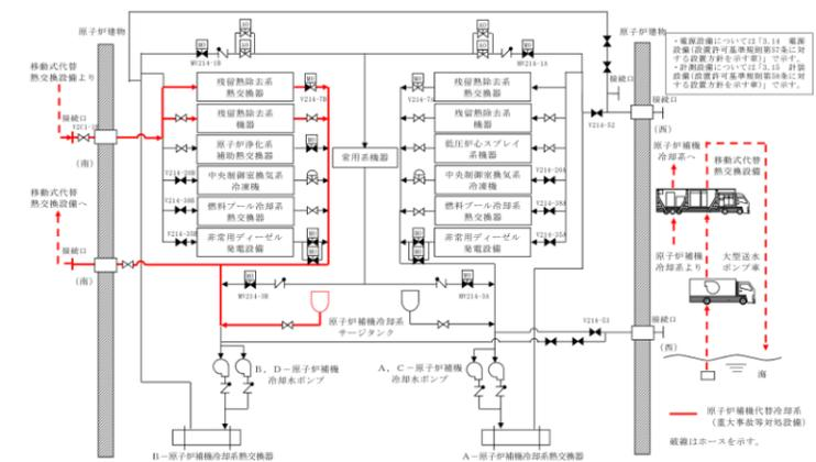
図 3.5-2 原子炉補機代替冷却系 系統概要図 (B系の例)
