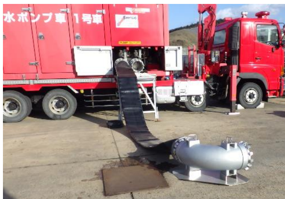
大型送水ポンプ車 (EL8.5m (荷揚場にて模擬操作))
