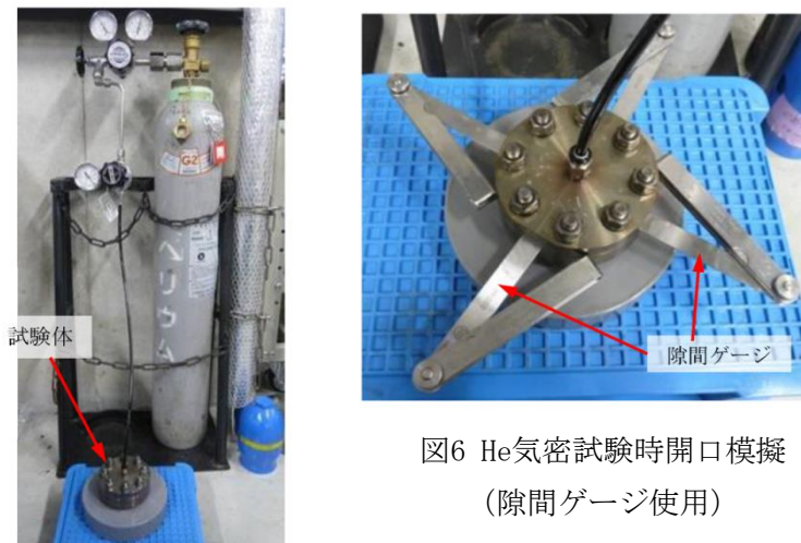
図5 He気密確認試験状況
