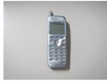
電力保安通信用電話設備 (PHS 端末)
