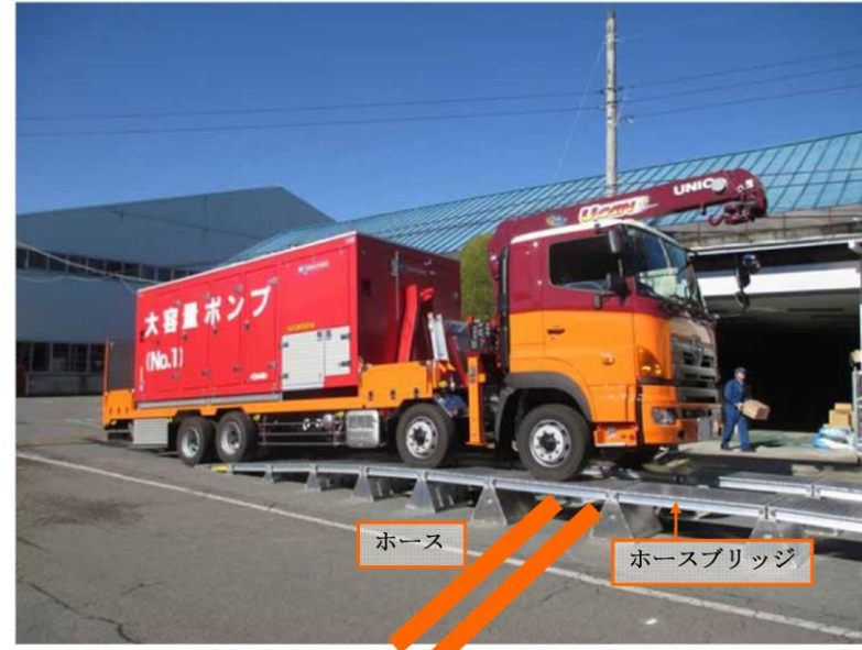
第1図 ホースブリッジ及び車両通行概要図
