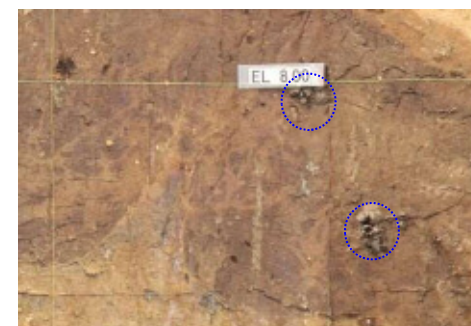
P12: 径5cm～数mm程の炭化木片が散在している。
