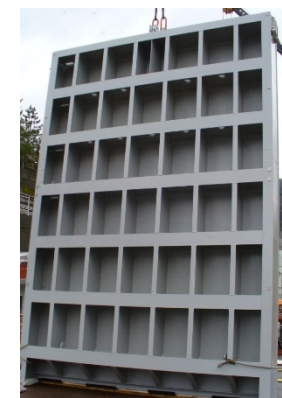
【取水路下流側から見たゲート扉体】
