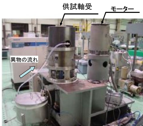
図-2 海水ポンプ軸受摩耗試験装置
