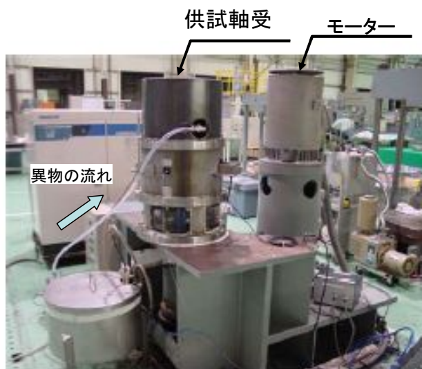
図-2 海水ポンプ軸受摩耗試験装置
