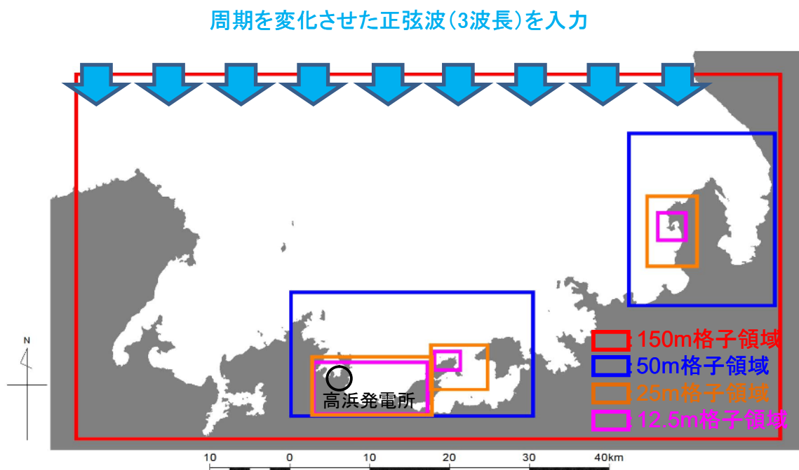
図 14 正弦波入力による検討概要（計算領域及び空間格子間隔）
