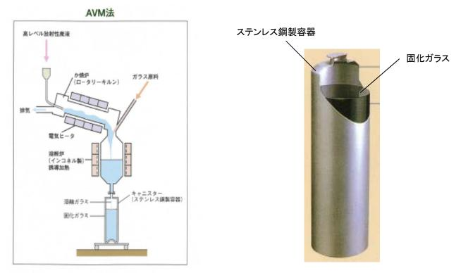
仏国、英国で採用されているAVM(Atelier de Vitrification de Marcoule)法 (誘導加熱型金属溶融炉)で製造されたガラス固化体
