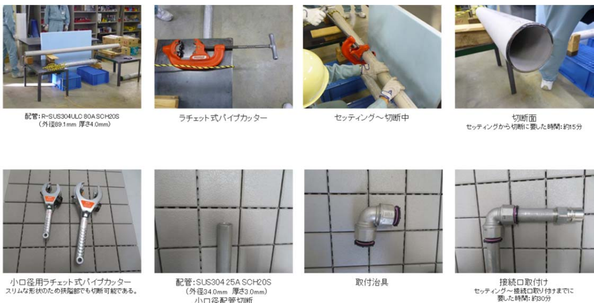
第2. -37 図 配管切断実証訓練
